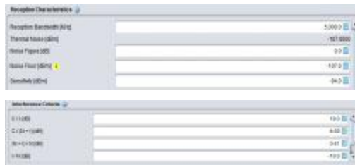
그림 7. 희생링크 수신기 수신 특성 및 간섭 기준 설정 Fig. 7. Setting Receiver Characteristics and Interference Criteria for the Victim Link Receiver
